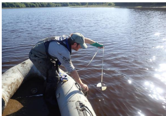
Figure 7 : Mesure de la transparence avec disque de Secchi sur l'étang de Moulin Neuf
