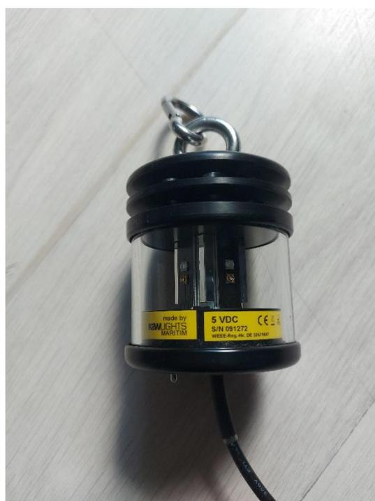
Figure 24: « lepiLED » utilisée comme dispositif d'attraction des papillons de nuit
